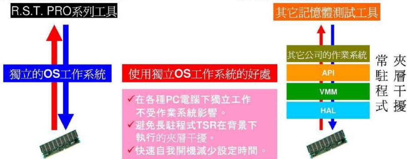
直接利用硬體對硬體通道的命令來執行真正的低層級的記憶體測試。不受任何干擾操作系統，裝置驅動器和常駐程式 TSR。在卡上自我載入程式不需依靠任何作業系統，RST 獨自去執行最底層的測試。
